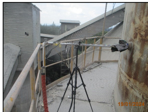
ภาพที่ 3.13 การตรวจวัดคุณภาพอากาศจากปล่องหม้อเย็น 6
